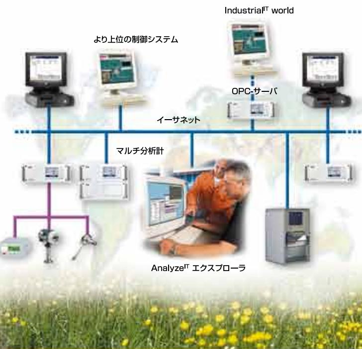
分析計の遠隔制御などの操作機能の向上、効果的な設備管理ならびに中央の保守コンピュータからのソフトウェアのバージョンアップが可能です。先進のソフトウェアツールも利用可能です。本システムは、今日では一般に使用されているフィールドバスシステムならびに従来の4...20 mAアナログ出力をサポートしています。
